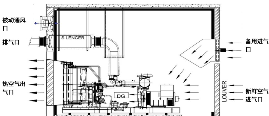
房间或储存区域必须满足多个目的；隔离发电机以减少噪音和对其周围环境的环境影响，并防止工作人员、访客、动物或其他人的未经授权进入。即使发电机相对暴露在外，例如没有四壁的遮阳篷，仍建议控制对发电机的访问。在发电机的储存区域中，可能需要在发电机的一侧或多侧建造额外的墙体以阻挡噪音和盛行风。
