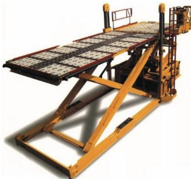
**集装箱/空运托盘搬运机**——一种专为在停机坪或跑道上移动超大尺寸集装箱和空运托盘而设计的特种车辆。托盘搬运机配有辊和其他设备，可以快速装卸货物，并可与强光灯和其他物料搬运设备搭配使用。
