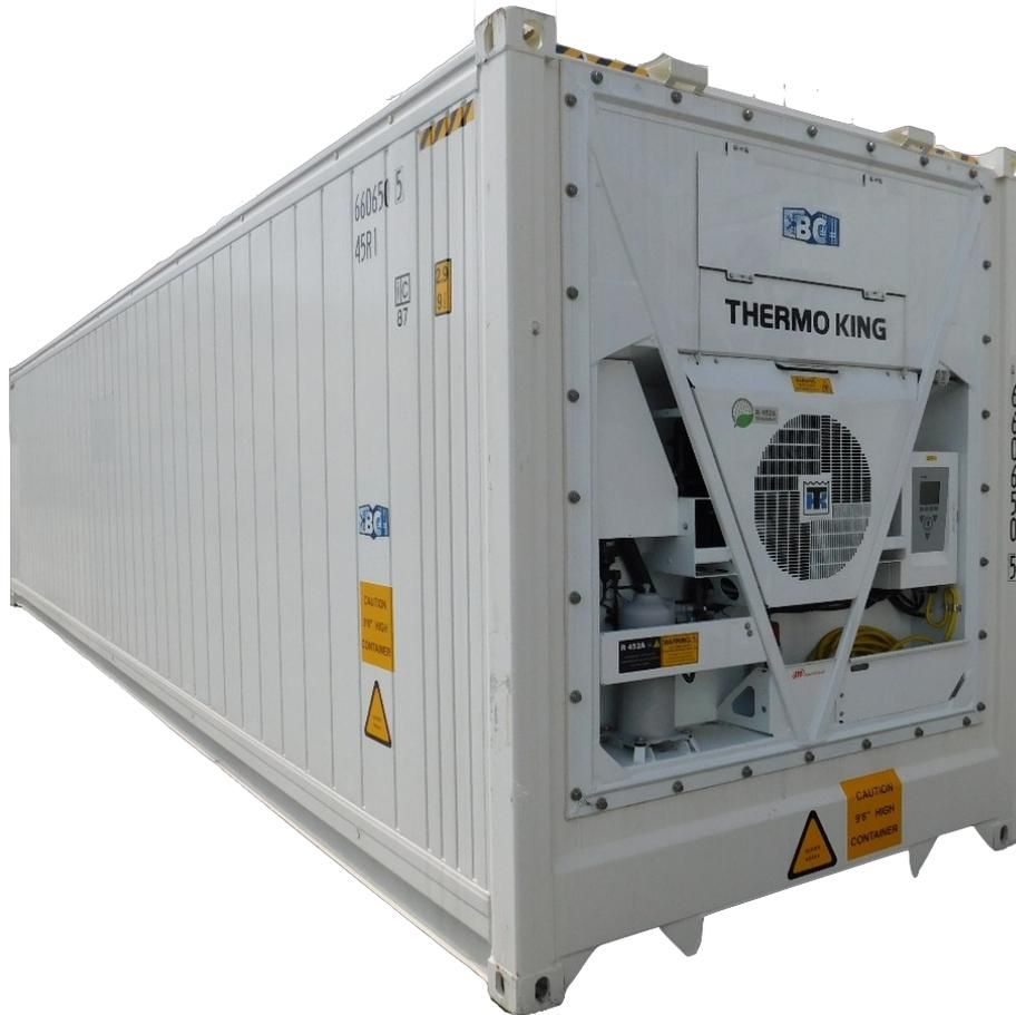
所有用于海运的冷藏集装箱都必须经过所谓的装箱前检查 (PTI)。除非冷藏集装箱为货物发运人所有，否则由船运公司负责进行 PTI。PTI 对集装箱、制冷设备和监测设备的状况进行验证，根据航运公司的需求和公司政策，额定期限为 30 到 120 天。
