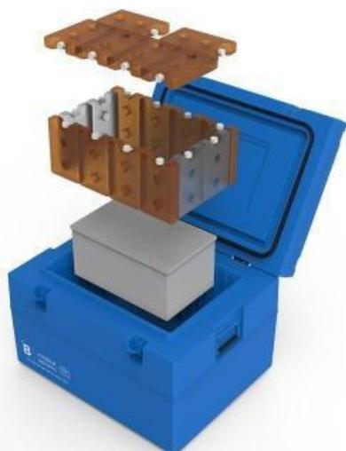
**疫苗运输箱** - 隔热的可重复使用的容器，在将疫苗（和稀释剂）从配备冷藏设施的医疗机构运输到没有冷藏设施和冰的疫苗接种点的过程中，可让疫苗（和稀释剂）保持低温。疫苗运输箱比冷箱要小，因此更便于以徒步或其他方式出行的卫生工作者个人携带，其总行程时间和免疫活性范围为几个小时到一整天不等。疫苗运输箱的储存容量介于 0.1 到 5.0 升之间。
