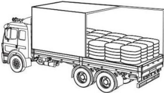
**大件货物**——对于木材、发电机或其他大型设备等大件货物，应使用适当强度的绳索或链条将货物牢牢地固定在卡车车厢底板上。
