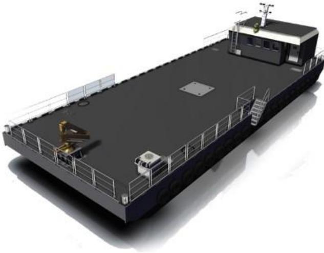
**无动力**——“无动力”驳船是一种非独立驱动的浮动平台，能够装载货物，但没有转向装置或发动机。无动力需要外部船只才能移动，包括拖船或“顶推船”，也就是一艘独立的动力船，专为在水道上推或拉无动力驳船而设计。
