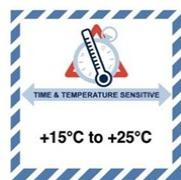
国际航空运输协会的时间和温度敏感标签（自 2012 年起强制要求）。标签下半部分不得留空，必须注明运输货物的外部运输温度范围，可以手写或打印在标签上。
