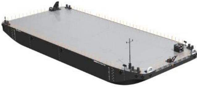
**泥驳/分体式泥驳** ——一种内有一个较大或多个较小舱室的驳船，舱室部分位于驳船船舷下。其舱室可储存大宗散货，例如谷物、沙子或矿石。许多舱室可用防水布或硬金属盖覆盖以保护内容物，有时甚至可在舱室顶部额外储存货物。根据货物的不同，泥驳/分体式泥驳可以人工装载或由专用物料搬运设备装载。
