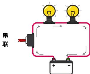
“串联”连接的基本概念是将组件端到端地连成一条线，形成一条电流流经的单一路径：
