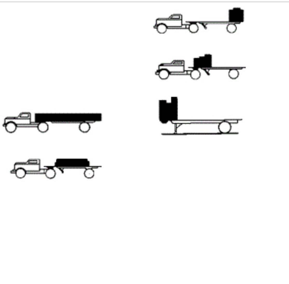
无论为什么类型的车辆装车，都要确保货物重量在车厢底板的短边方向上居中。货物重量过于偏离一侧或另一侧会导致车辆不稳定、影响转向甚至导致车辆倾覆。
