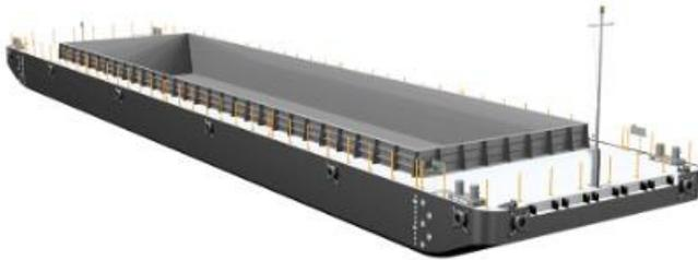
**油驳船** ——设计用于运载液体或压缩气体的驳船。油驳船需要专门的维护，并且只有在出发和目的地港口有合适的装卸设备时才能使用。
