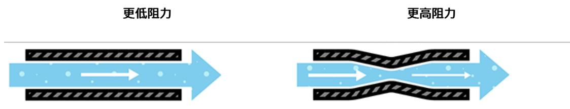
电阻 (R) 以欧姆表示。“1 欧姆”电阻单位的定义是在一个导体中两点间施加 1 伏特可推动 1 安培时的阻力。这一数值通常在示意图中用希腊字母“Ω”（称为欧米伽）表示，发音为“欧姆”。
