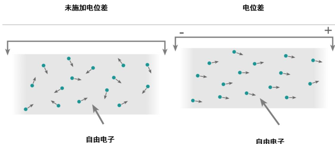
将灯泡连到发电机时，一定数量的电子会通过
