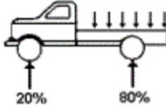
向平头或普通卡车重载货物时，先从后轴上方开始，让重量向后轴前方逐渐分布到车厢底板中心。货物过于接近驾驶室会遮挡驾驶员的后视线、增加制动距离，并会因重量分布不均而降低在道路行驶时上的牵引力。货物过于靠后会更加不稳定，还可能导致牵引力问题。应尽可能避免将货物伸出小型卡车后部很远——过长的货物不仅会导致车辆重量失衡，还可对其他车辆和乘客带来危险。
