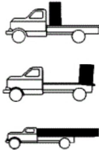
牵引车/挂车配置设计为将货物重量保持在两个车轴之间。为牵引车装车时，应让重量均匀地分布在车厢底板中心，为没有牵引车的挂车装车时，可让货物重量稍微向后轴移动。
