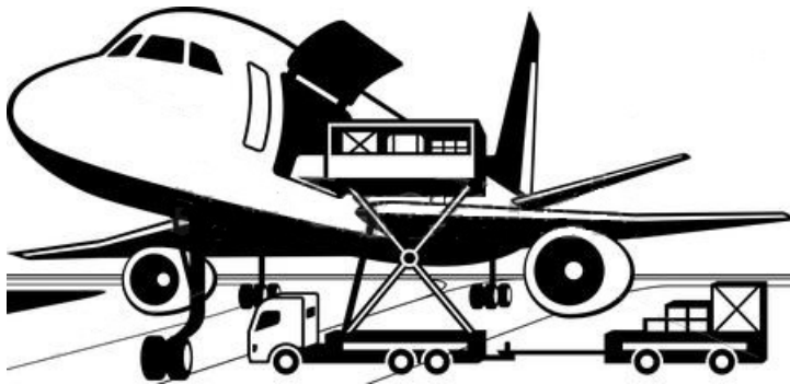
K 型装载机——在飞机旁装载货物时需要使用的高升降机。
